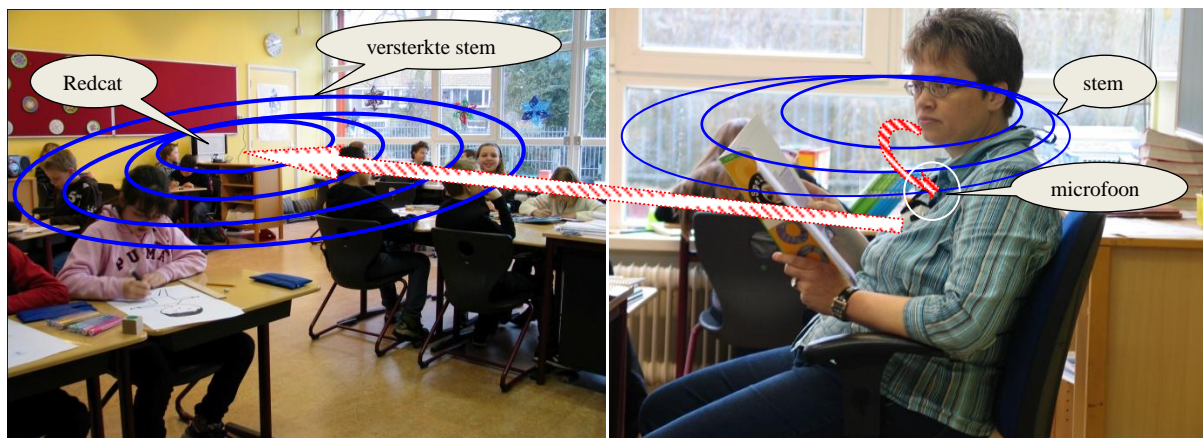
Figuur 1. Het stemgeluid van de leerkracht wordt opgevangen door de leerkrachtmicrofoon en door middel van infrarood techniek (afgebeeld als pijl) gezonden naar het klassenversterkingsapparaat Redcat , dat achter in de klas staat. Van hieruit wordt het geluid gelijkmatig door de klas verspreid. © A. Voor in 't holt, 2010.
